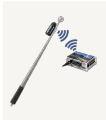
打音検査棒の開発 (トンネル内装工の不良箇所を検出)
